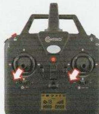
La calibración del giroscopio se ha realizado en la fábrica por defecto. La calibración del giroscopio no es necesaria, a menos que el drone no puede salir del procedimiento de detección de inicialización, después de que se ha finalizado esta detección de inicialización. Asegúrese de colocar el drone en una superficie horizontal y totalmente plana, cuando vaya a llevar a cabo la calibración, si no se proceder de esta forma, el rendimiento de vuelo se verá afectado.
