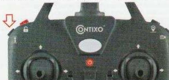
Cuando el drone aterrice y los motores se hayan parado, el drone estará bloqueado. Debe desbloquearlo de nuevo para que vuelva a despegar.
